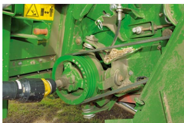
Lewa strona przenośnika pochyłego, na skrzyni przekładniowej rewersera
