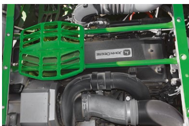
Górne i boczne powierzchnie silnika, odsłonięte obszary turbosprężarki oraz powierzchnie okładzin
