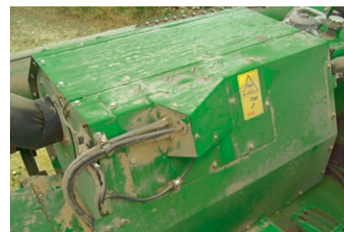
Obszar wokół zbiornika oleju hydraulicznego i układu wydechowego
