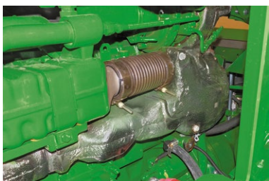
Kolektor wydechowy, osłona kolektora, rura międzystopniowa turbosprężarki i rura chłodnicy systemu recykulacji spalin (EGR)
