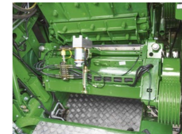
Układ elektrycznej regulacji szczeliny zgniatacza ziarna BXE10569 zamontowany w modelu 8300 z roku modelowego 2016
